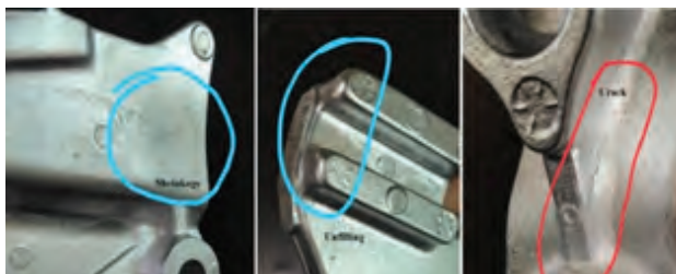
a) Shrinkage b) Unfilling c) Crack
